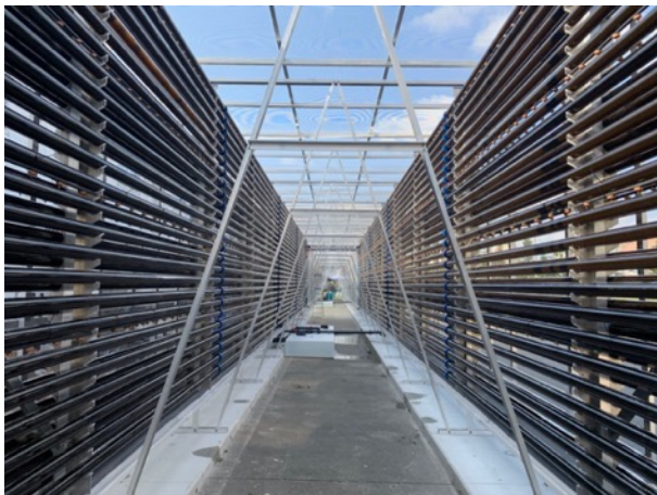
ガラスチューブ外径：65mm、チューブ総延長：約5km 水量1,000L×2基、水量7,000L×2基、トータル水量：16ton
