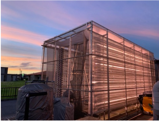
水量1,000LのフォトバイオリアクターにはLEDを設置しており、ハイブリッド方式（自然光, 人工光）での培養が可能です。
