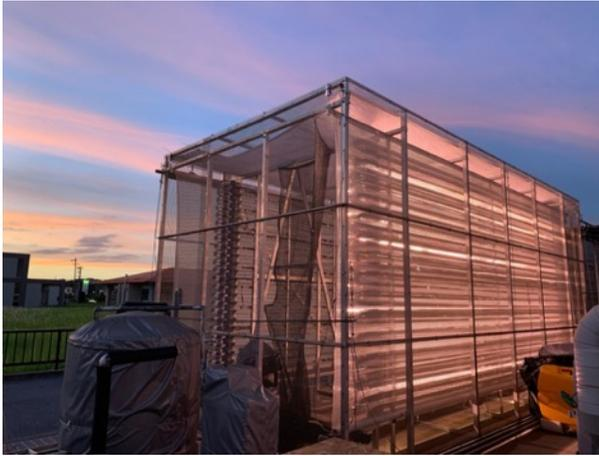
水量1,000LのフォトバイオリアクターにはLEDを設置しており、ハイブリッド方式（自然光, 人工光）での培養が可能です。
