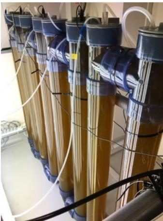
意匠登録しているオリジナルのバッチ式フォトバイオリアクター（25L：8本、5L：20本以上保有）を用いて、小規模での培養条件検討や1ton タイプの前段階の培養をおこなっています。
